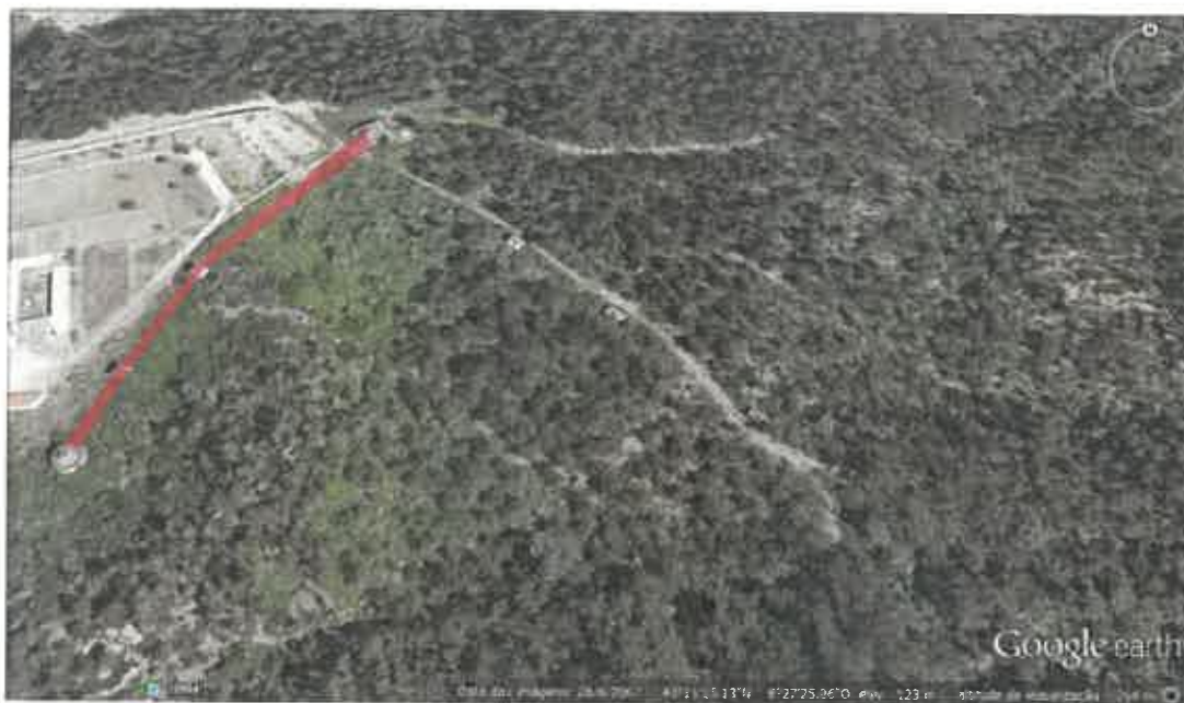
Imagem 23 - Imagem do Google Earth onde se vê o início do aqueduto de Santa Clara. Tem o seu início na nascente da Granja, em Santa Clara, seguida de dois respiradouros e indo desembocar a uma mãe de água de estrutura paralelepipedal com remate piramidal.
