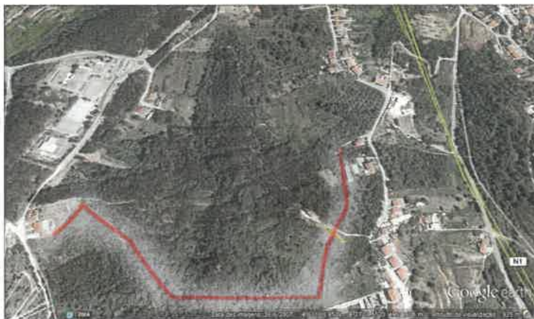
Imagem 38 – Prolongamento do aqueduto até ao respiradouro que se encontra dentro de um quintal de uma habitação.
