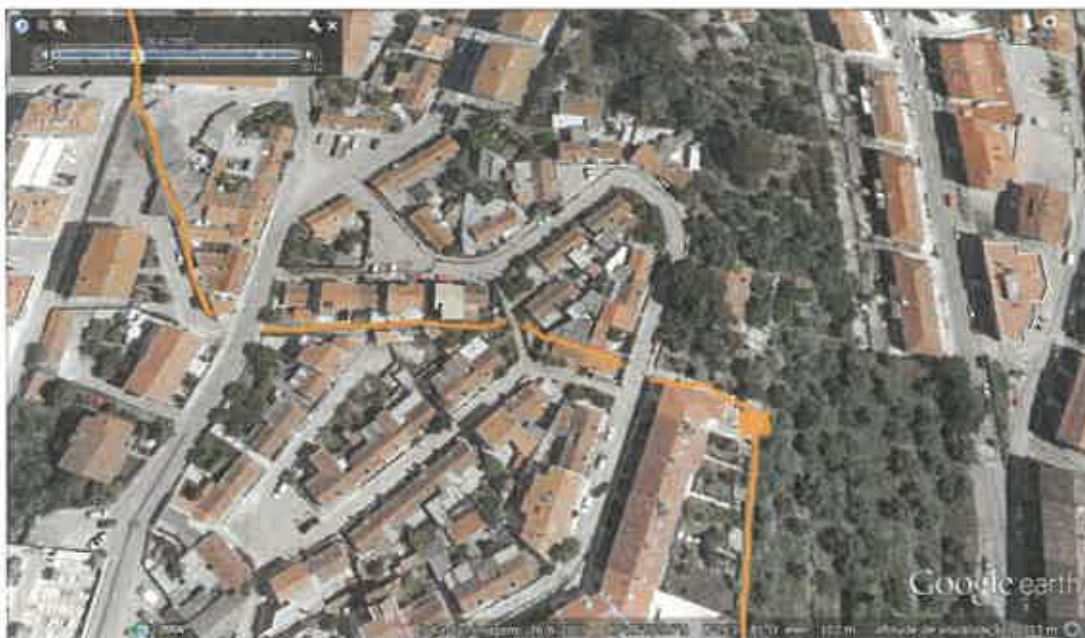
Imagem 79 – imagem do Google Earth com a marcação do aqueduto, onde podemos ver a nova urbanização e novas estradas que passam por cima do aqueduto e que não constam nos planos de Manuel Alves de Macomboa.
