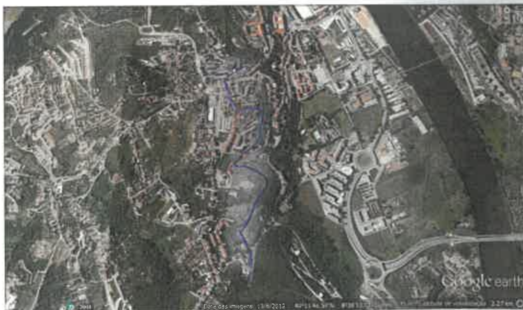
Imagem 54 – Sobreposição do trajecto do aqueduto do Real Mosteiro de Santa Clara, desenhado por Manuel Alves Macomboa sobre imagem do Google Earth.
